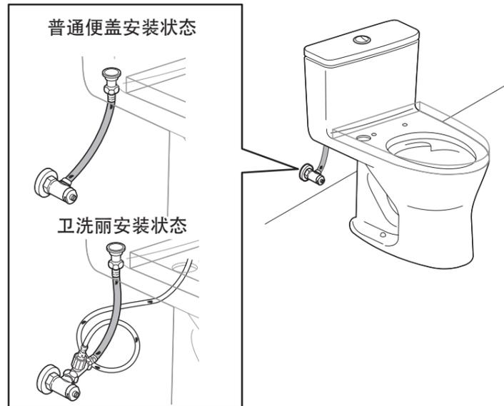
试运转后请对所有的安装部位，进行是否漏水的确认。
