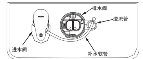
注意：务必使补水管的补水直接流入水箱中，否则会造成冲洗水量超出标示水量。请仔细确认！
