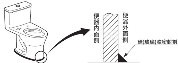
警告：禁止使用环氧树脂或硬化后体积变大的密封材料。
