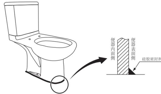
警告：禁止使用环氧树脂或硬化后体积变大的密封材料。
