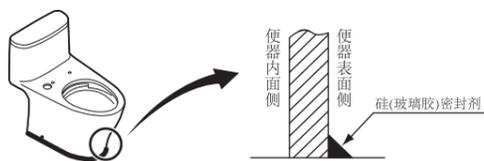
警告：禁止使用环氧树脂或硬化后体积变大的密封材料。
