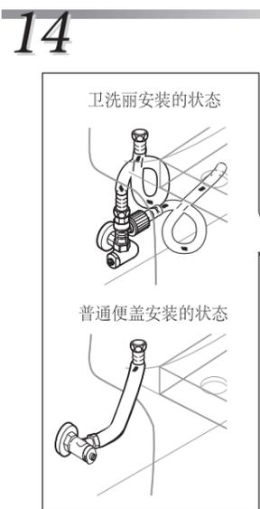
试运转后请对所有的安装部位，进行是否漏水的确认。如安装不良的话，可能会漏水导致财产损失。
