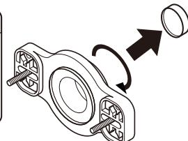
7. 将4个螺栓拧入法兰盘安装孔固定，然后套上橡胶密封圈。
