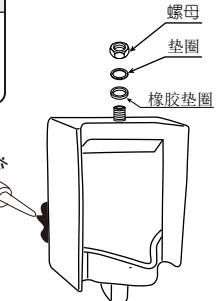
13. 安装冲洗阀，请按照冲洗阀安装说明书确保冲洗阀与给水连接件正确连接并确保不漏水。
