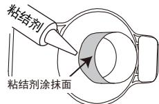
6. 将法兰盘插入排水管的过程中同时旋转一周，安装后确保法兰盘水平。
