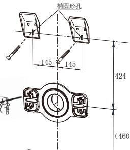
3. 将法兰临时插入排污管（先不要涂粘结剂），调整水平后，画出法兰盘4个固定孔位置。
