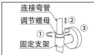
①逆时针拧开调节螺母，至连接弯管可上下移动的程度；
