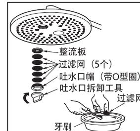
使用专用的吐水口治具拆卸吐水口，分解后注意各个部件不要丢失，用牙刷清洁过滤网。
