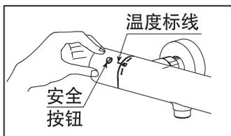
设有安全按钮，以防误操作而喷出热水。温度调节手柄被固定在“40”附近。若想进行高温出水(>40℃)，必须按下安全按钮，同时，旋转手柄。
