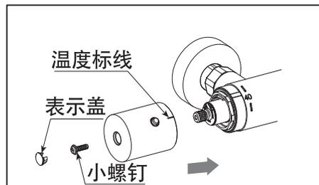
3. 将温度调节手柄上的温度标线与本体“40”居中对齐，将温度调节手柄装上，确认出水温度是 $40^{\circ}\text{C}$ 后，拧紧小螺钉，装上表示盖。
