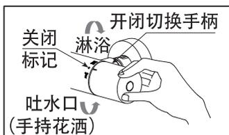
若将开闭切换手柄向自身方向旋转，从吐水口(手持花洒)中出水。若向后旋转，则从淋浴器中出水。旋到极限位置时，出水量达到最大。欲止住吐水，请将开闭切换手柄的标线对准本体的关闭标记。
