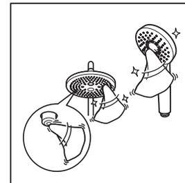
若使用时出现水线不均匀的现象，可用毛巾轻轻擦拭散水板上的小硅胶吐水口，清除异物。
