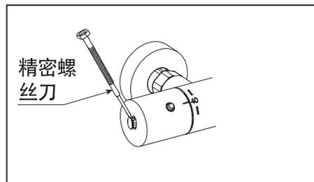
2. 拔出温度调节手柄时，请先取出表示盖，拧下小螺钉。
