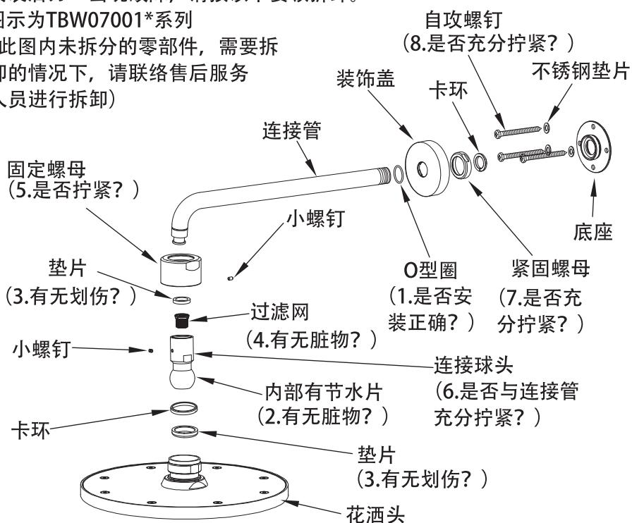
※注意:若出水不良,请用手揉搓几下吐水不良的小橡胶凸起。
