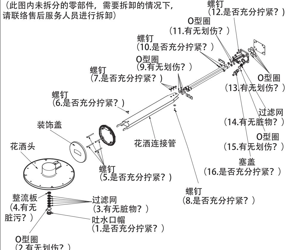
※注意:若出水不良,请用手揉搓几下吐水不良的小橡胶凸起。
