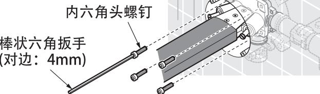
⑥再用L型六角扳手完全旋紧固定。
