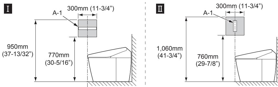
**10** 暂时安装在步骤⑨中所决定的位置后, 请确认A-1的信号接收状态。
