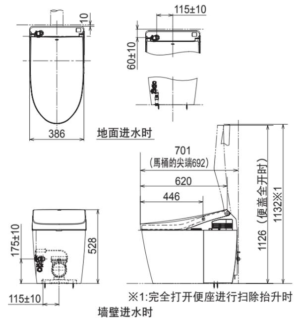
产品安装图 (安装完了图) RH型 (单位:mm)
