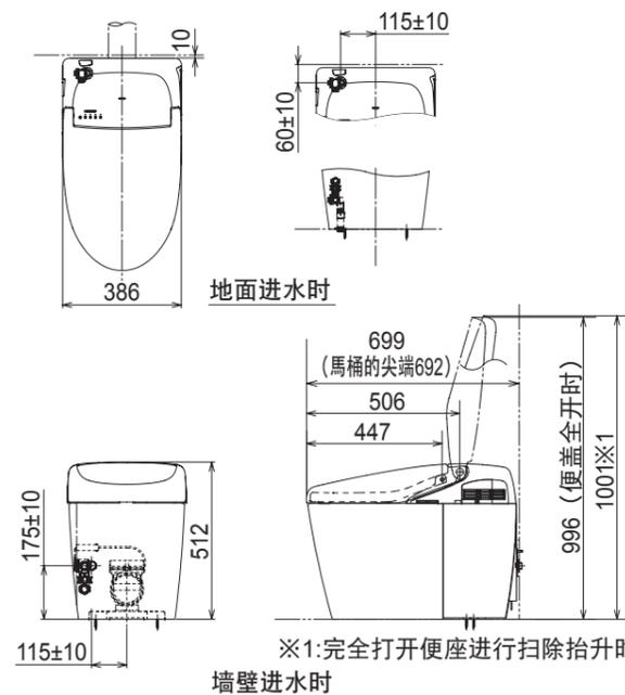
产品安装图 (安装完了图) DH型 (单位:mm)
