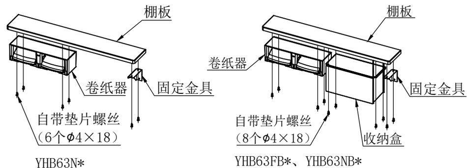
注意：组装棚板和手纸架时，如图1所示先向外拨动爪，放下纸切板，然后用指定螺丝把手纸架固定到棚板上组装好后再把纸切板恢复原位。
