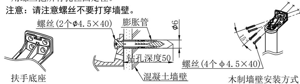
6. 底座固定好后, 按照图1所示方法把底座盖装上即可, 如有问题可按图2所示方法取下底座盖。
