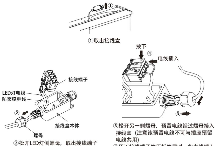
③松开另一侧螺母，预留电线经过螺母接入接线盒（注意该预留电线不可与插座预留电线共用）
