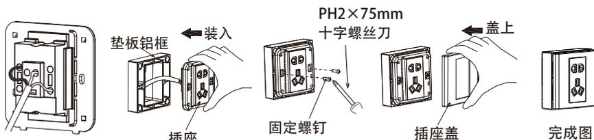
图9 ①将插座装入垫板铝框 ②拧紧固定螺钉 ③盖上插座盖
