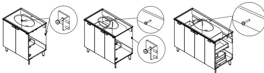
洗面盆必须用硅胶粘贴在台面上, 并安装固定金具。
