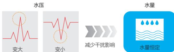
当水压波动时，通过定流量阀的伸缩，自动调节水量和水势，减少干扰影响，保持水量恒定。
