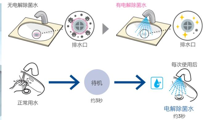
每次使用后，自动感应水嘴会自动待机3秒左右，期间如果没有感应到有人继续使用，水嘴将针对排水口，自动喷洒约3秒的电解除菌水，从而有效抑制排水口周边的细菌繁殖，保持洗面器的清洁。
