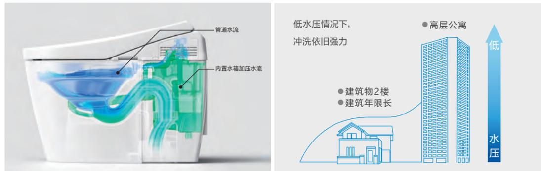
\* 进水要求: 0.05MPa(动压)-0.75MPa(静压)
