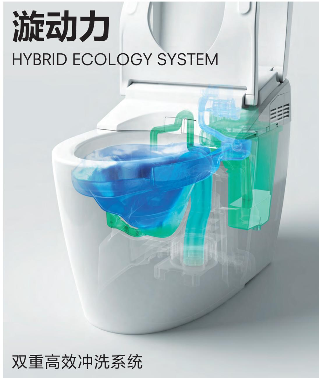
“漩动力”，水箱式冲洗加上管道直压水流冲洗，双效叠加，形成两股强劲水流，极大可能地提高了冲洗力。用少量的水就能有效清除污物，还无需二次冲洗清洁。即使在高层建筑中，冲洗力依然出众。
