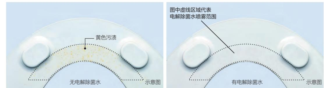
试验方法：对采用便器底部电解水除菌技术的产品和无此功能的产品进行测试
