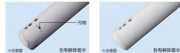
实验方法：为研究电解除菌水效果是否显著，采用有电解除菌水功能的自清洁喷嘴与普通自清洁喷嘴进行比较，并观察洁净效果。（实验期间禁止清洗坐便器。）
