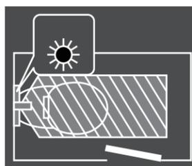
初始安装期间无需调节阀门。自动调节隔间内的反射防止误感应。
