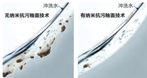
减少容易藏污纳垢的陶瓷表面凹凸。采用智洁技术的坐便器内壁，釉面空隙小到纳米水平，几乎不给污垢容身的空间。
