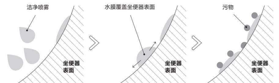
每次使用前，都会喷洒水雾。利用陶瓷亲水性，使污物更易清洗干净。
