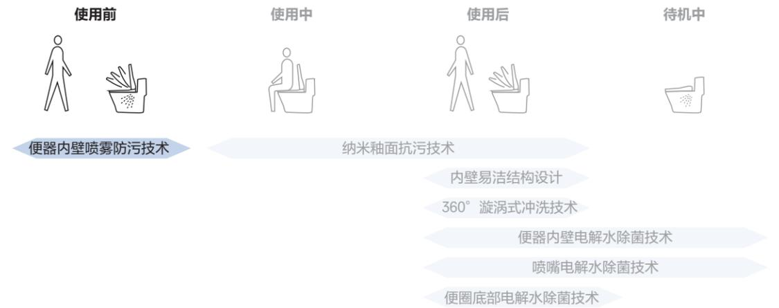
每次使用前，都将会在便器内壁上喷洒水雾。利用陶瓷的亲水性，使污物更易清洗干净。
