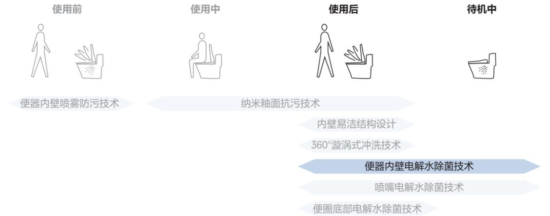
喷嘴和坐便器内壁容易受污垢、细菌污染，难免出现黑斑。电解除菌水能够对喷嘴和坐便器内壁进行清洁除菌。不添加化学物质和清洁剂，让您每天都能放心使用。
