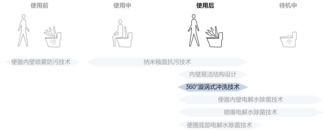
360°漩涡式冲洗技术在确保高效冲洗的同时，还实现了节水、静音。强劲的水流形成360度漩流，全方位冲洗无棱坐便器内壁。
