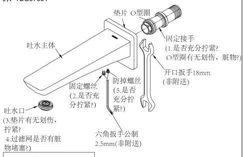
叶水口拆卸工具:可用1元 硬币或类似工具拆卸。
