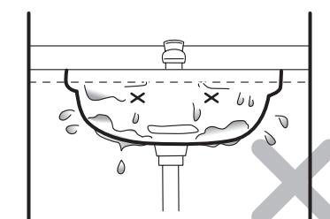
避免硬物落入洗脸盆上会造成洗脸盆破损。
