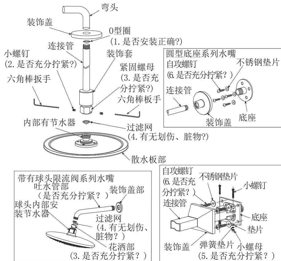
※注：若出水不良，请用手揉搓几下吐水不良的小橡胶凸起。
