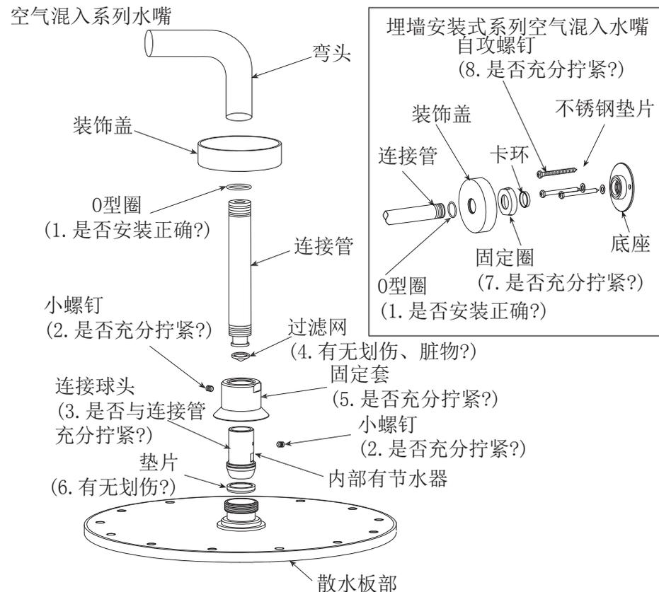
※注：若出水不良，请用手揉搓几下吐水不良的小橡胶凸起。
