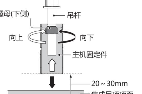
(3) 将主机暂时固定部(排气接口侧)卡入主机固定件的“L”字形状部,另外一侧也同样卡入。
