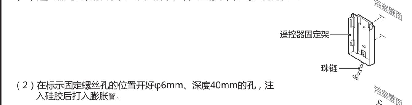
(2) 在标示固定螺丝孔的位置开好φ6mm、深度40mm的孔, 注入硅胶后打入膨胀管。
