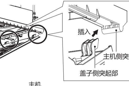
(2) 为了保证盖子牢固固定,右图中盖子上○(3处)向上按压,使盖子内侧的挂钩卡入主机内。
