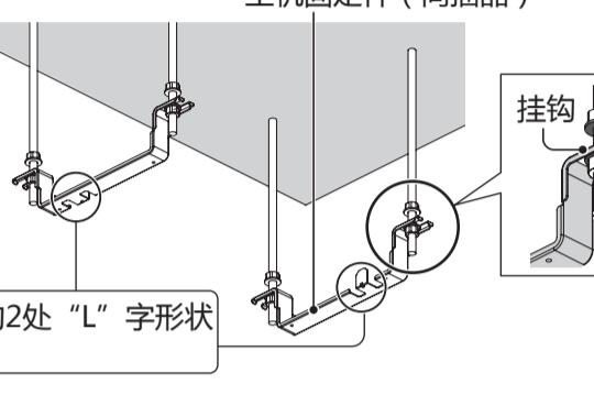
(2) 调整吊杆下侧的螺母,使主机固定件的底端与集成吊顶底面间距20~30mm。
