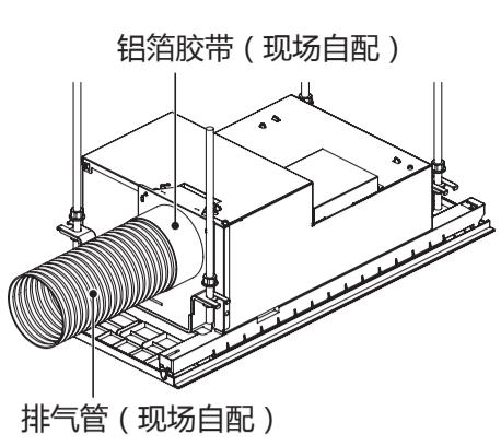
(2) 将排气管连接到排气管的连接口上, 用铝箔胶带封住以免漏风。(口径φ100)
