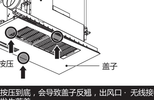
(3) 用盖子固定螺丝(同捆品)将盖子与主机固定。
