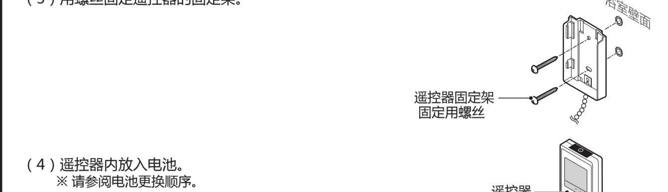
(3) 用螺丝固定遥控器的固定架。
