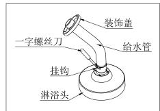
①如上图所示,用一字螺丝刀对准 挂钩与淋浴头间的间隙,轻轻撬动 即可拆卸。
