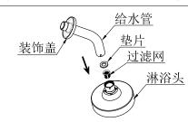
①将过滤网、垫片依次装 入淋浴头与给水管用扳手 旋紧连接。
