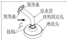
②将防脱落挂钩一端挂入淋浴头 固定孔内,另一端挂入另一侧固 定孔内固定。
