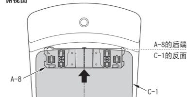
② 将C-1插入A-8, 直到听到“咔嚓”声为止。(安装后, 轻拉C-1, 确认其不会脱离。)
