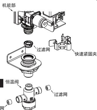
关闭进水角阀后，再取下过滤网盖子。
