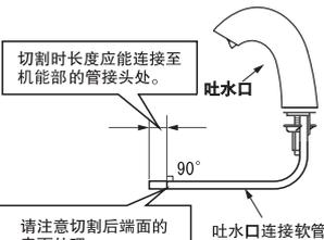
② 将吐水口连接软管插入管接头。
