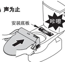
**注意** 没有正确安装时,请拆下卫洗丽本体,重新安装安装底板。
